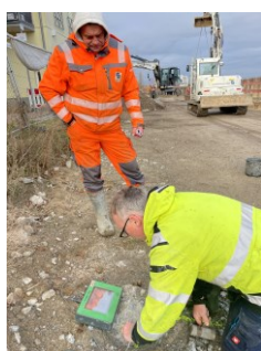
Links: Prüfung der Bohrpfähle in der hinteren Reihe 11-12/2024
